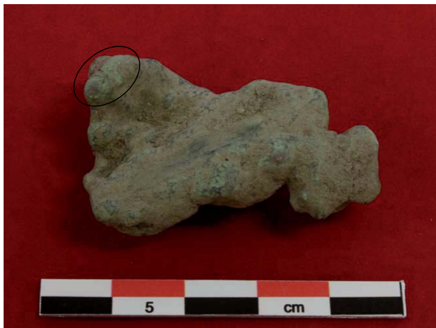
Figur 1. Den analyserade smältan från Rambodal 1:3, Styrstad socken, Östergötland. Prov för analys är taget vid den markerade ringen.
